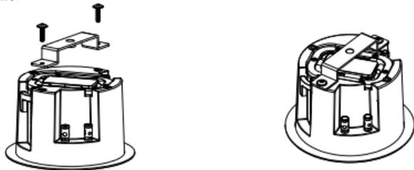
用“十”字螺丝刀或电动启子将铁片挂钩固定在音箱背面;确保锁紧无滑牙情形;
