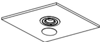
最后将铁网装入音箱槽沟内,确定装配
