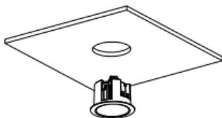
将预留电线穿入音箱接线柱孔里。
